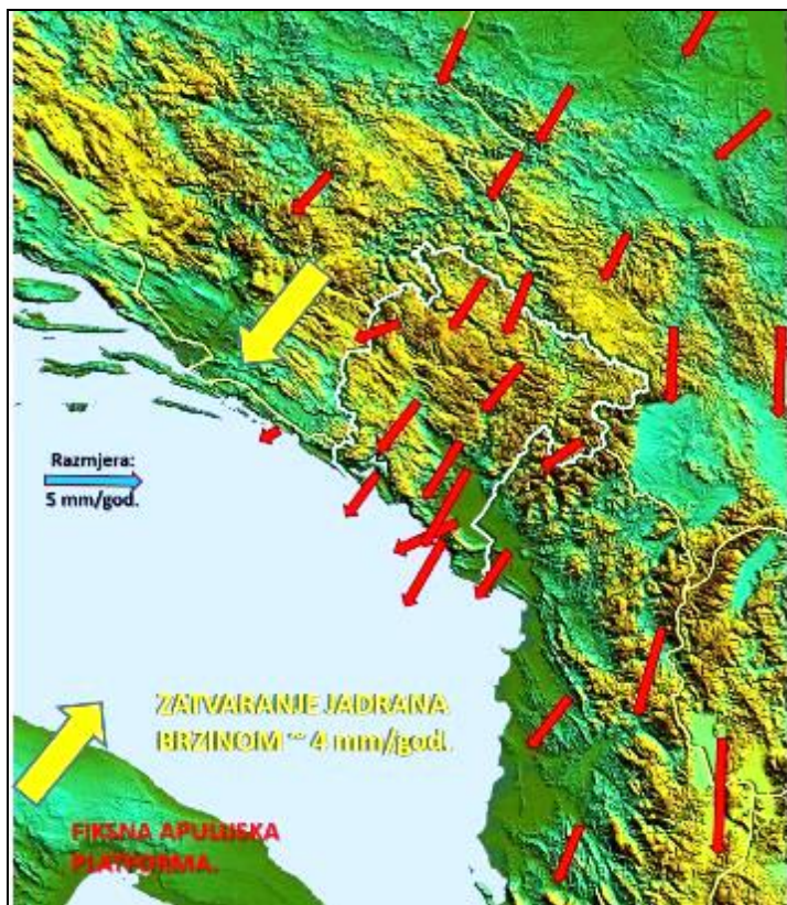
Slika br.24: Kinematski horizontalni vektori segmenata zemljine kore na prostoru Crne Gore i okruženja, u uslovima relativnog fiksiranja apulijske platforme, na osnovu višegodišnjeg permanentnog GPS osmatranja na većem broju
