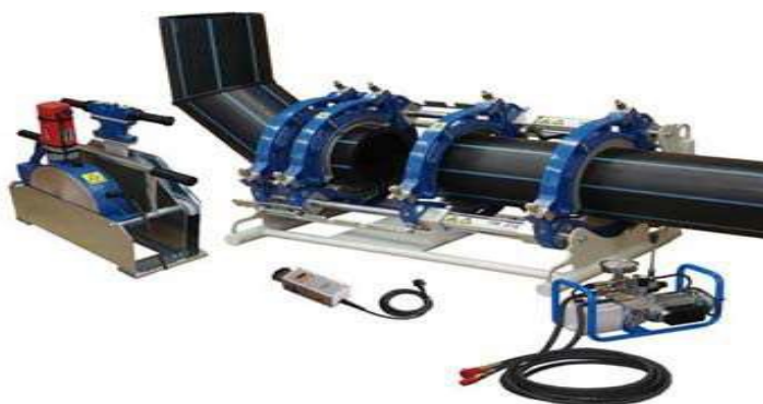
Slika 3.5.: Oprema za čono zavarivanje PEHD cijevi
