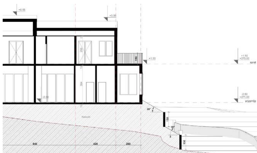
Slika 2. Presjek sa prikazanim nasipom
