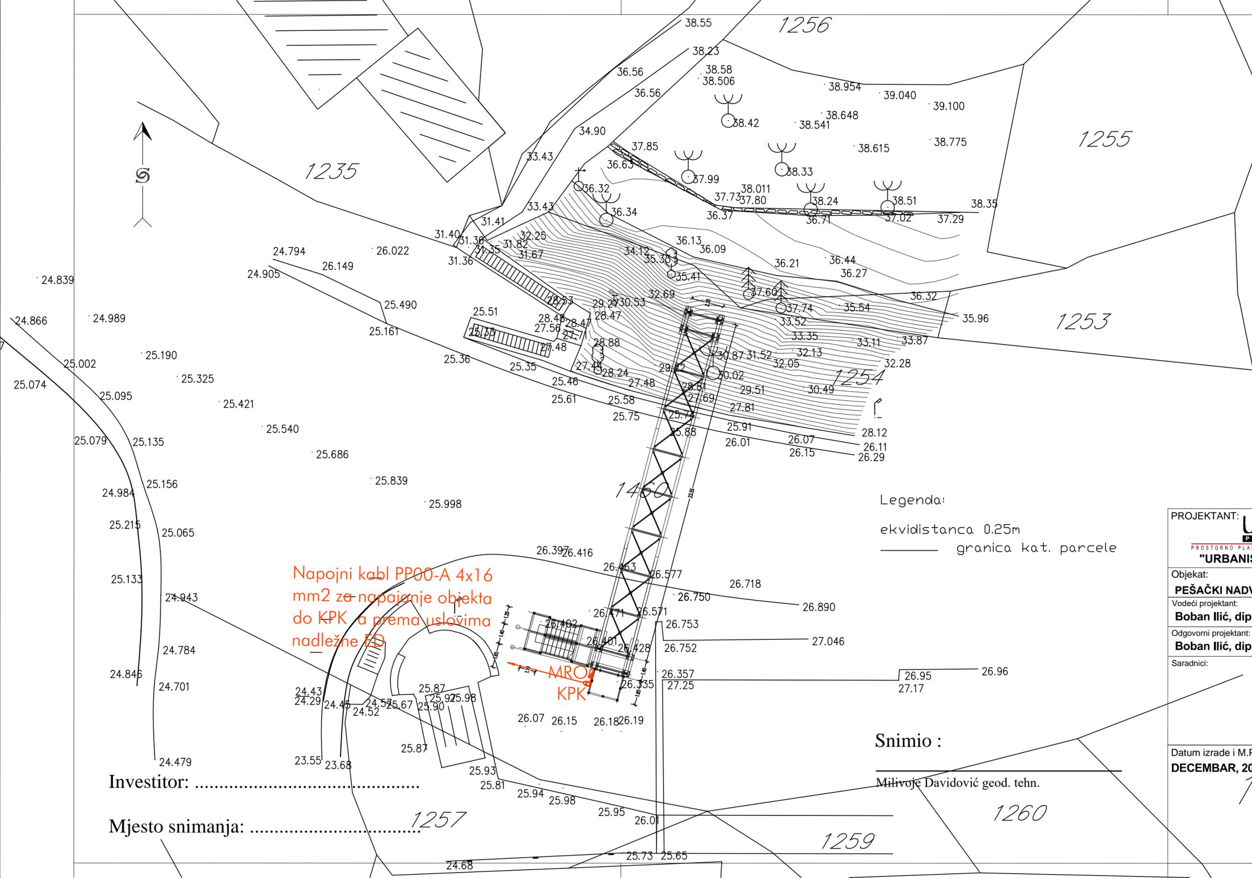
Napojni kabl PP00-A 4x16 mm<sup>2</sup> za napajanje objekta do KPK a prema uslovima nadležne ED
